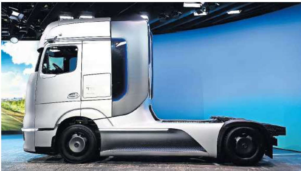
Ein Prototyp eines Lasters, wie ihn Daimler vorgestellt hat. Er fährt mit Strom aus Wasserstoff. Die Technologie will der Kaiserslauterer „Blue Corridor“ beispielsweise für die Flotte der Abfallverwertung nutzen.
